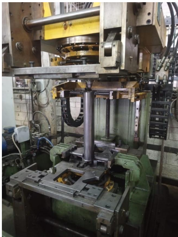
Рисунок 2.6 - Станок для отбортовки глушителей, марка «МС.07V.»
